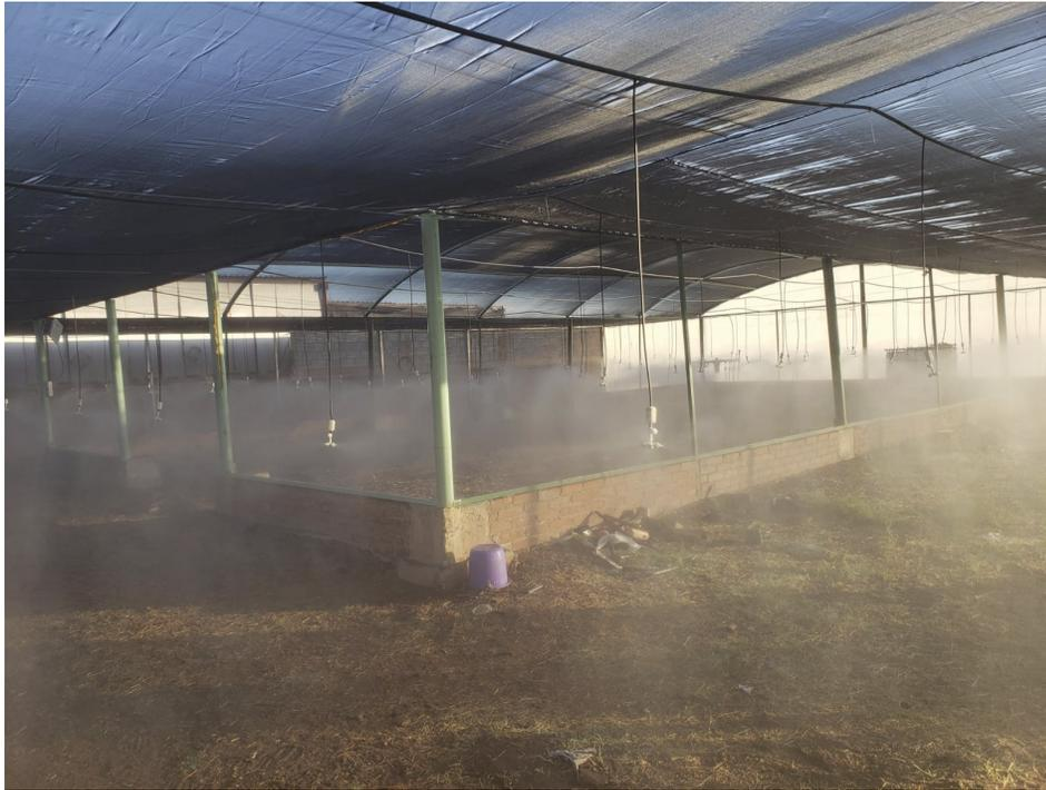
Ilustración 10 Sistema de riego por nebulización en vivero para producción plántula de agave
